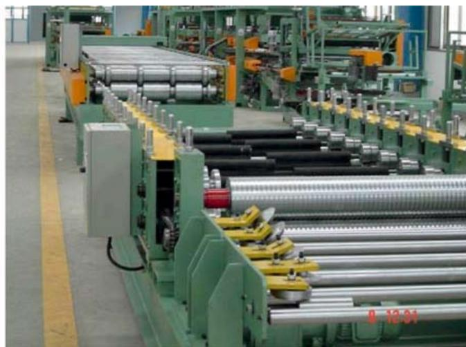
3. Один комплект корпуса производственной линии для сэндвич панелей с металлическим теплоизоляционным покрытием.
